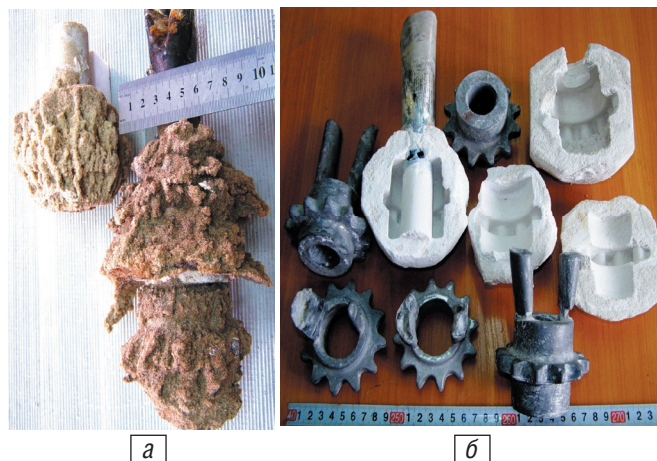
Рис. 3. Внешний вид оболочек (а), распиленные оболочки и пять отливок (б), четыре из них – с элементами литниковых систем
