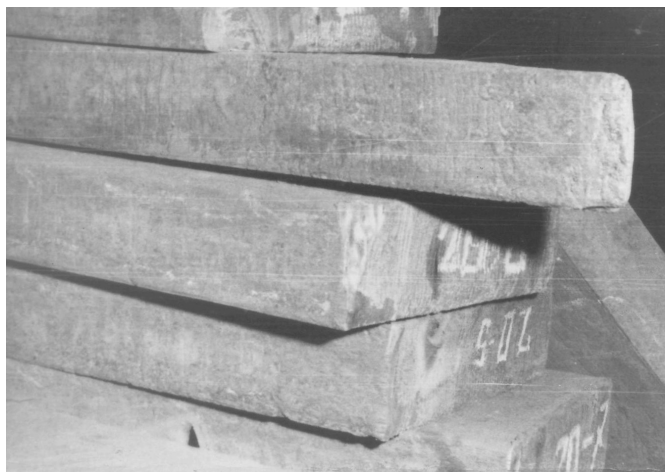
Рис. 6. Слябы, полученные на опытной НП МНЛЗ
