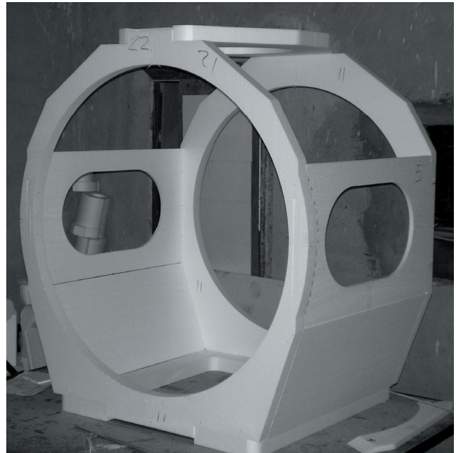
Рис. 1. 3D-образ пенополистироловой модели литой заготовки корпуса генераторного отсека
