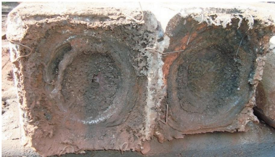
Рис. 2. Внешний вид головной части слитков, утепленных теплоизолирующей смесью ТИС-1П
