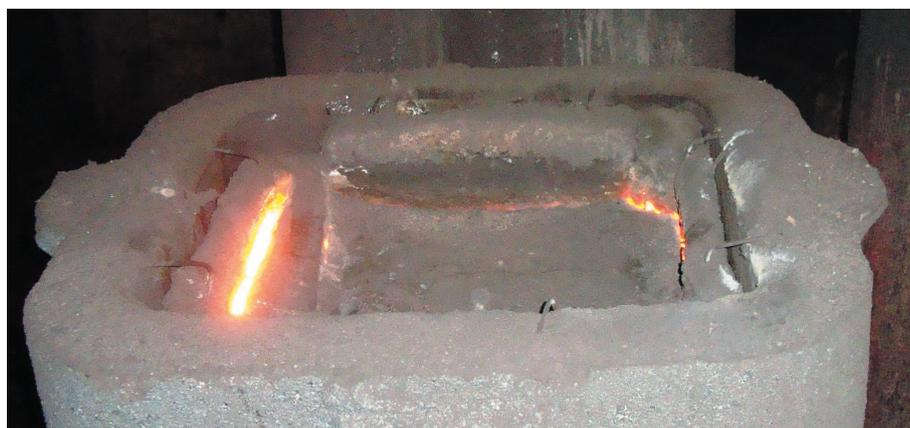
**Рис. 1.** Внешний вид смеси ТИС-1П при утеплении головной части уширенного книзу слитка массой 9 т
