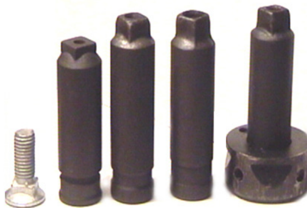
Рис. 1. Электроды-инструменты для обработки квадратного отверстия с фаской
