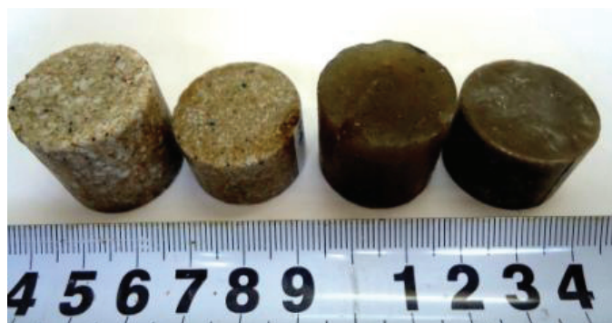
Рис. 4 Образцы для: испытания на прочность по табл. 1 (а); изучения поверхности излома столбчатых и пластинчатых образцов композитного материала различной толщины (б)
