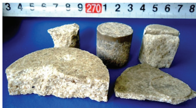
Рис. 4 Образцы для: испытания на прочность по табл. 1 (а); изучения поверхности излома столбчатых и пластинчатых образцов композитного материала различной толщины (б)
