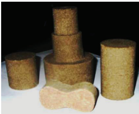
Рис. 2. Образцы для испытаний смеси на сжатие и на разрыв, литейные стержни из смеси для литейного производства
