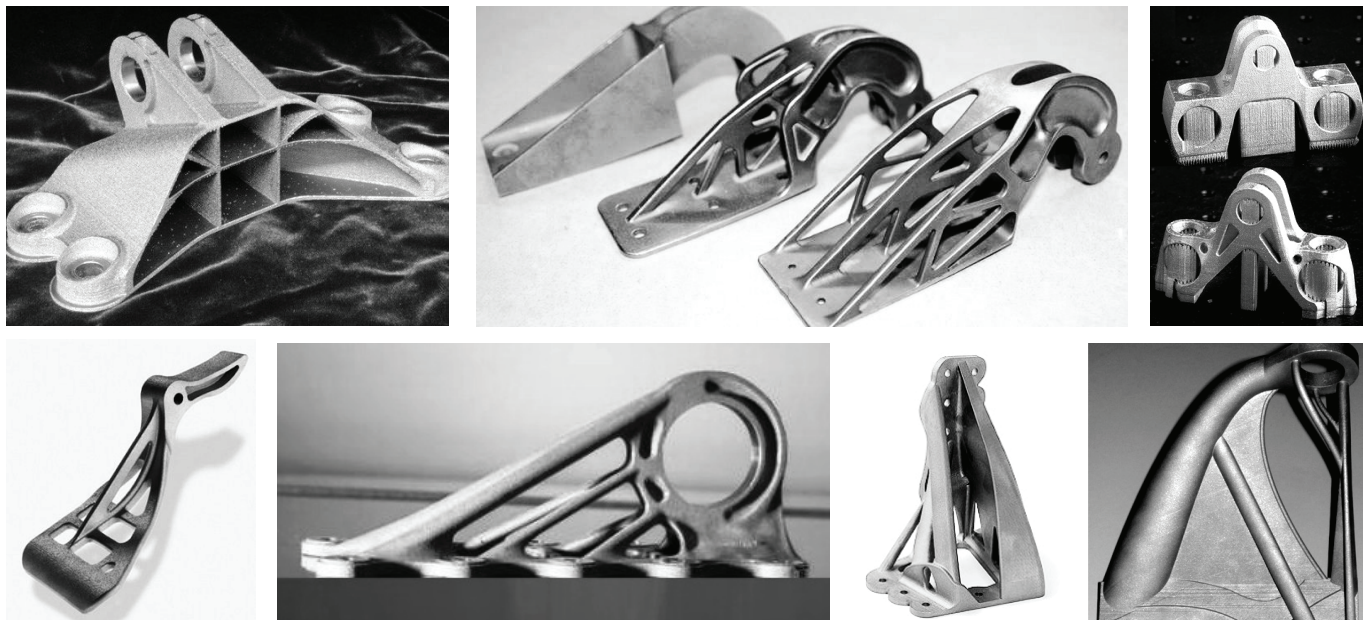
Рис. 3. Варианты 3D-печати различных кронштейнов
