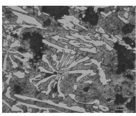
Рис. 11. Структура хромомарганцевого чугуна 280X20Г4Тц (4,4% Mn): а – в литом состоянии; б – после ступенчатого отжига, \times 500
