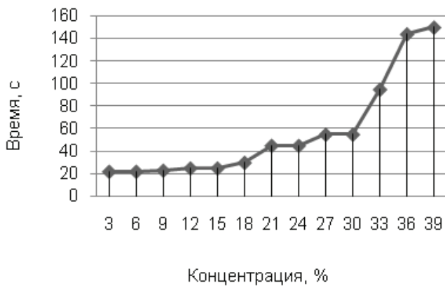
Рис. 6. Зависимость времени растворения пенополистирола от его концентрации в растворителе № 646
