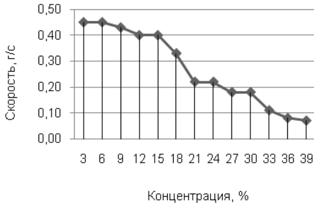
Рис. 7. Зависимость скорости растворения пенополистирола от его концентрации в растворителе № 646
