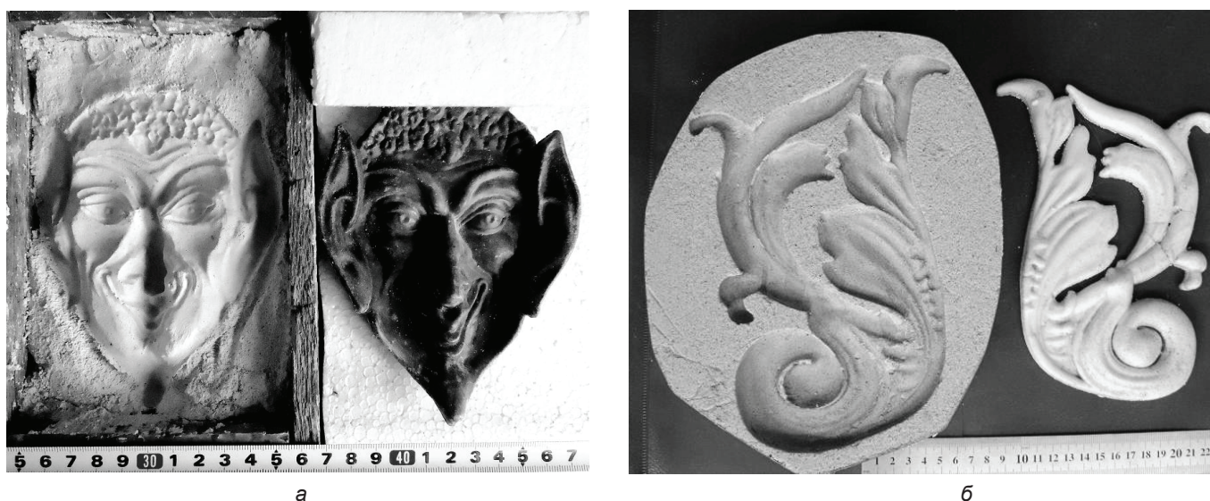
Рис. 3. Примеры послойной формовки при изготовлении песчаных полуформ: по металлической модели «Мефистофель» (а) и орнамента по ледяной модели (б)
