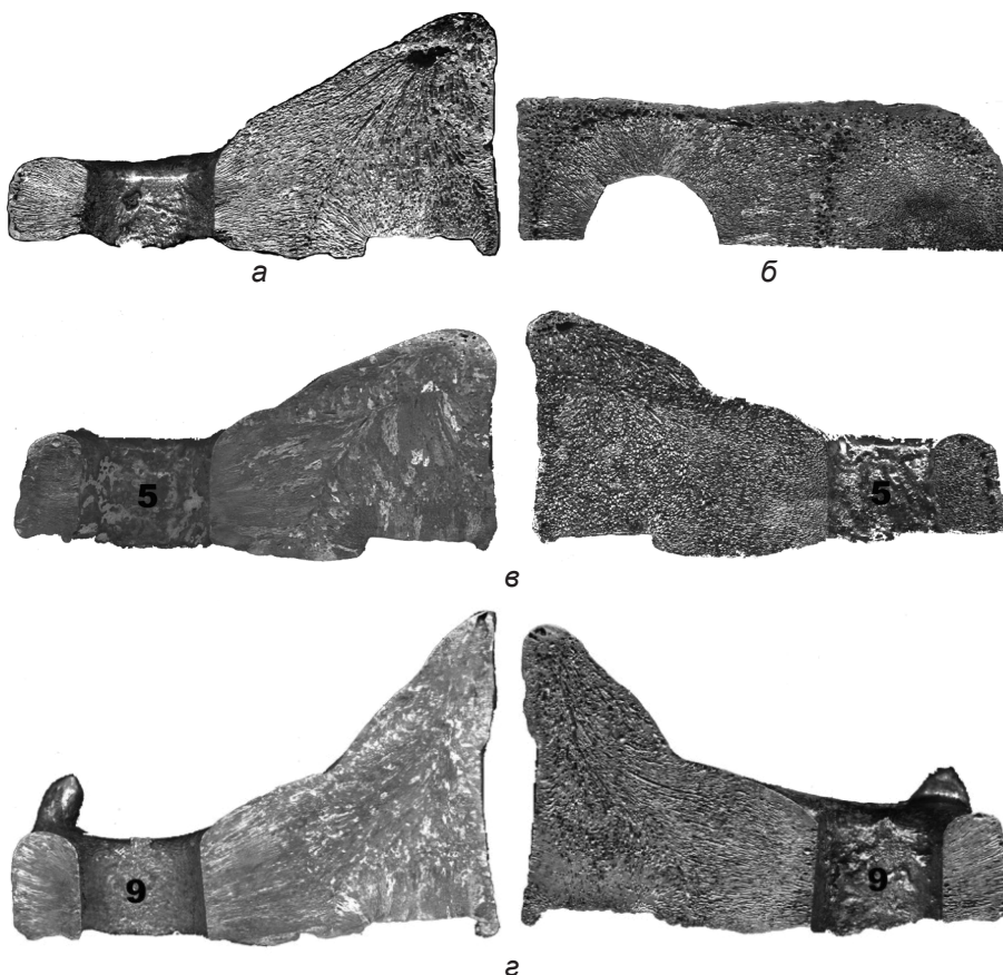
Рис. 5. Макроструктура медного газа, полученного при различных параметрах процесса: а, б – P_{нас.} = 0,2 , а P_{кр.} = 0,1 МПа; в – P_{нас.} = 0,3 и P_{кр.} = 0,4 МПа; г – P_{нас.} = P_{кр.} = 0,3 МПа
