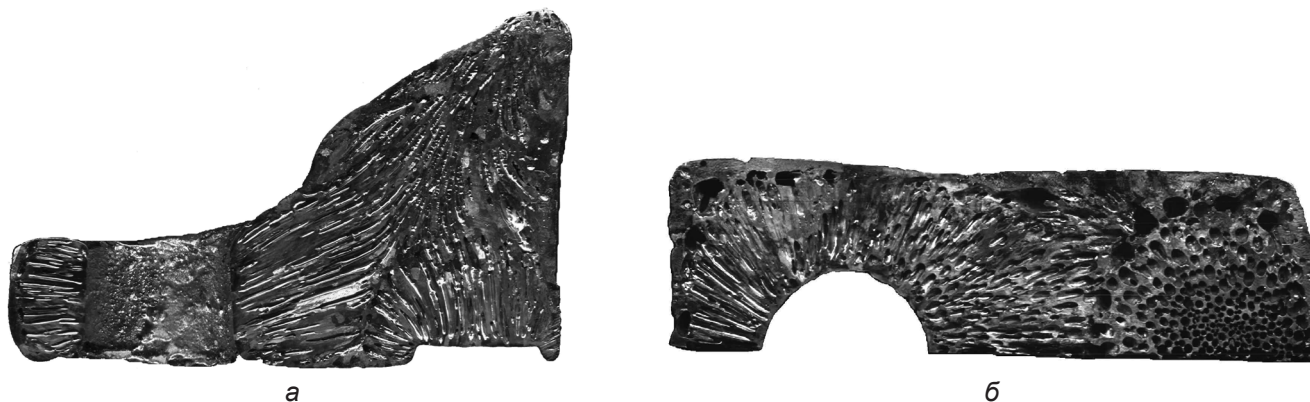
Рис. 4. Макроструктура медного газа с радиальным и аксиальным фронтами кристаллизации и наличием крупных пор слияния: а – продольное сечение; б – поперечное сечение отливки ( P_{нас.} = 0,1 , а P_{кр.} = 0,05 МПа)
