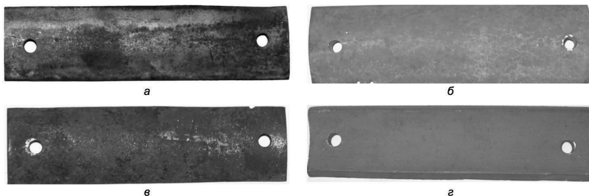
Рис. 3. Вид поверхности образцов, отобранных от НКТ группы прочности Р-110, после промышленных испытаний в скважине: а, в – образцы без покрытия; б, з – диффузионно оцинкованные образцы
