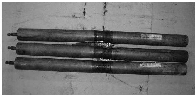
Рис. 4. Муфты (разрез) и НКТ группы прочности Д после гидроиспытаний коррозионной средой по методике NACE: образцы полностью погружали в испытательный раствор NACE (5%-ый раствор NaCl по ГОСТ 4233 + 0,5%-ый раствор CH_3COOH по ГОСТ 19814, насыщенный сероводородом, pH \leq 3,5 ; T = 297 К). Время испытаний – 720 часов.
