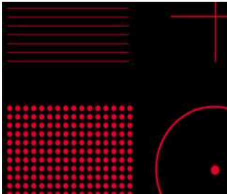
Рис. 8. Возможности различных насадок-фильтров для систем лазерной подсветки
