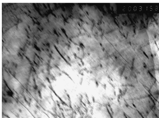
Рис. 2. Частинки VN в сталі 17X15Г19АФ після старіння при 700 °C (трансмійний аналіз фольг на електронному мікроскопі EM 125K). x 37000.
