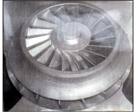
Рис. 3. Вилівок робочого колеса компресора.
