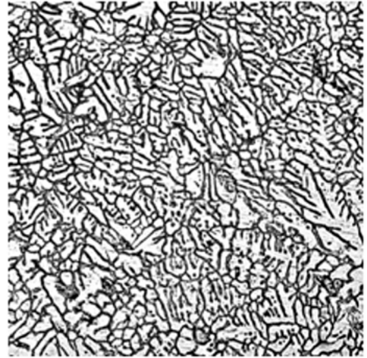
Рис. 1. Вихідна структура швидкоохолодженої при кристалізації ( V_{\text{ox}} = 250^{\circ}\text{C} ) шихтової заготовки сплаву АК4. \times 100 .
