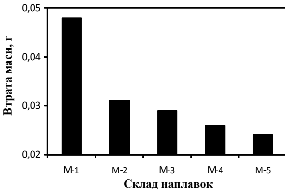
Рис. 4. Вплив складу наплавки на втрату її маси при абразивному зношуванні.
