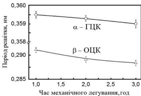
Рис. 4. Вплив часу МЛ на період ґратки ГЦК та ОЦК твердих розчинів порошкового AlNiCoFeCrTi сплаву, отриманого МЛ з наступним відпалом при температурі 1200 °С протягом 1 год.
