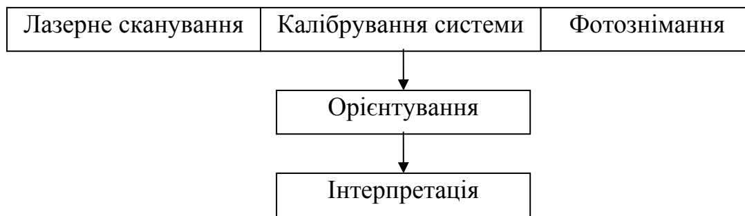
Рис. 4 Глибоко інтегрована схема лазерного сканування і фотограмметрії
