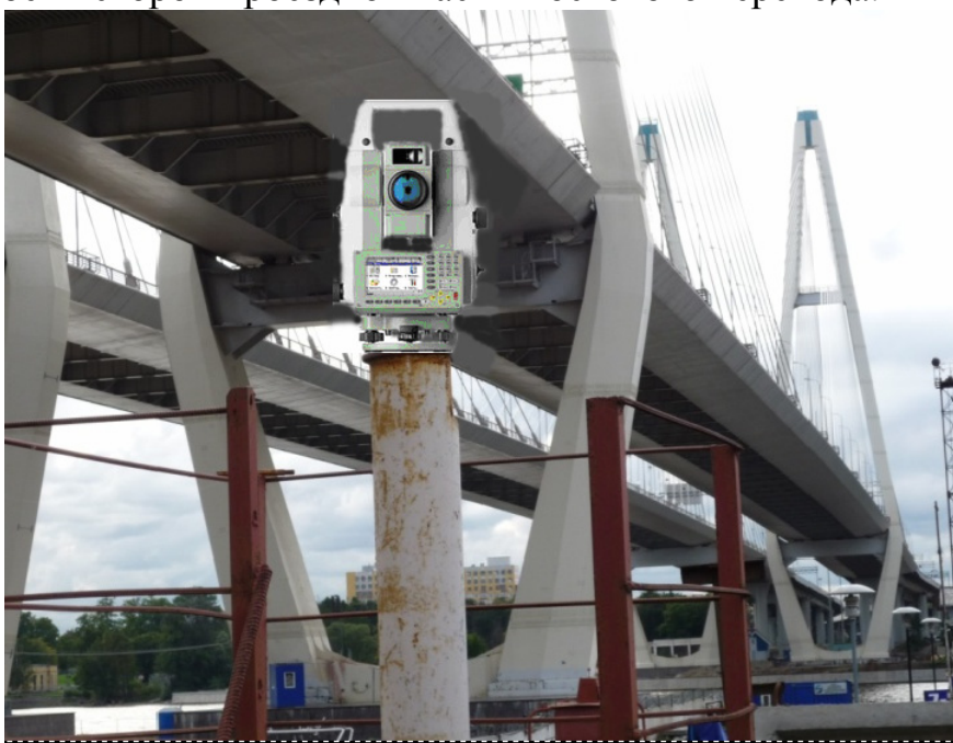
Рис. 5. Высокоточный тахеометр Leica TM 30
