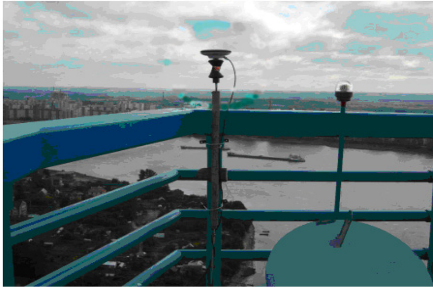
Рис. 2. Установка GPS приемника на точке мониторинга.
