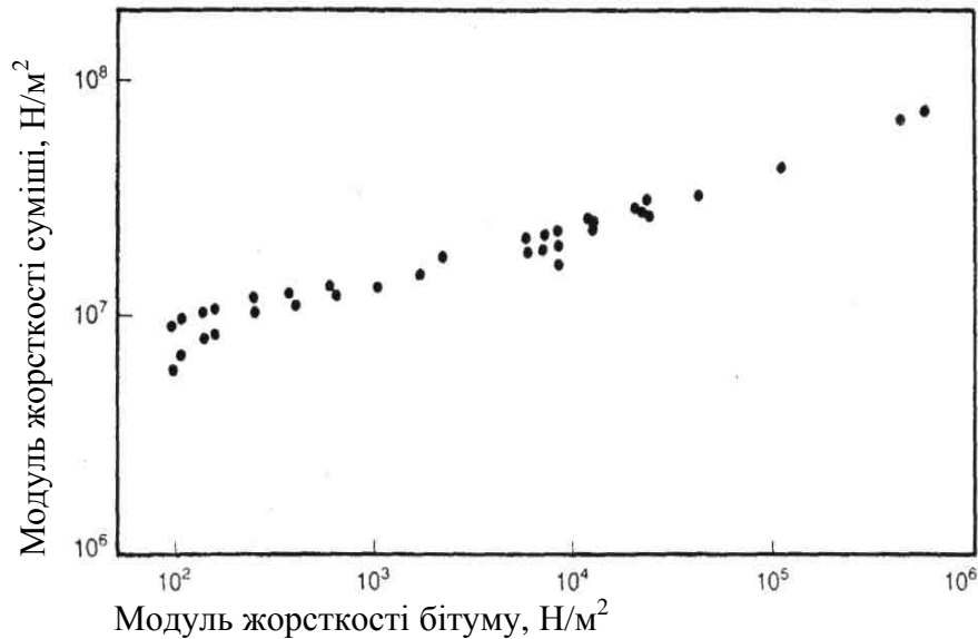
Рис.6. Модуль жорсткості бітуму, вплив на модуль жорсткості суміші (дослідження повзучості).
