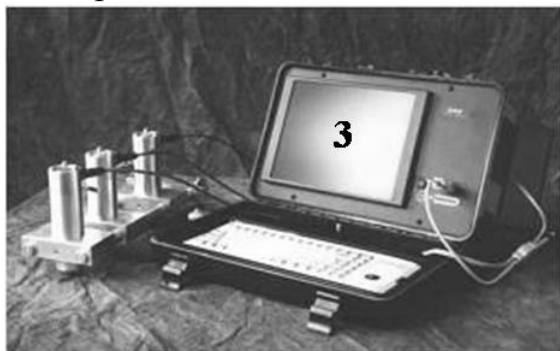
Рис. 7 - Обладнання для реєстрації та обробки параметрів розповсюдження поверхневих хвиль типу Релея
