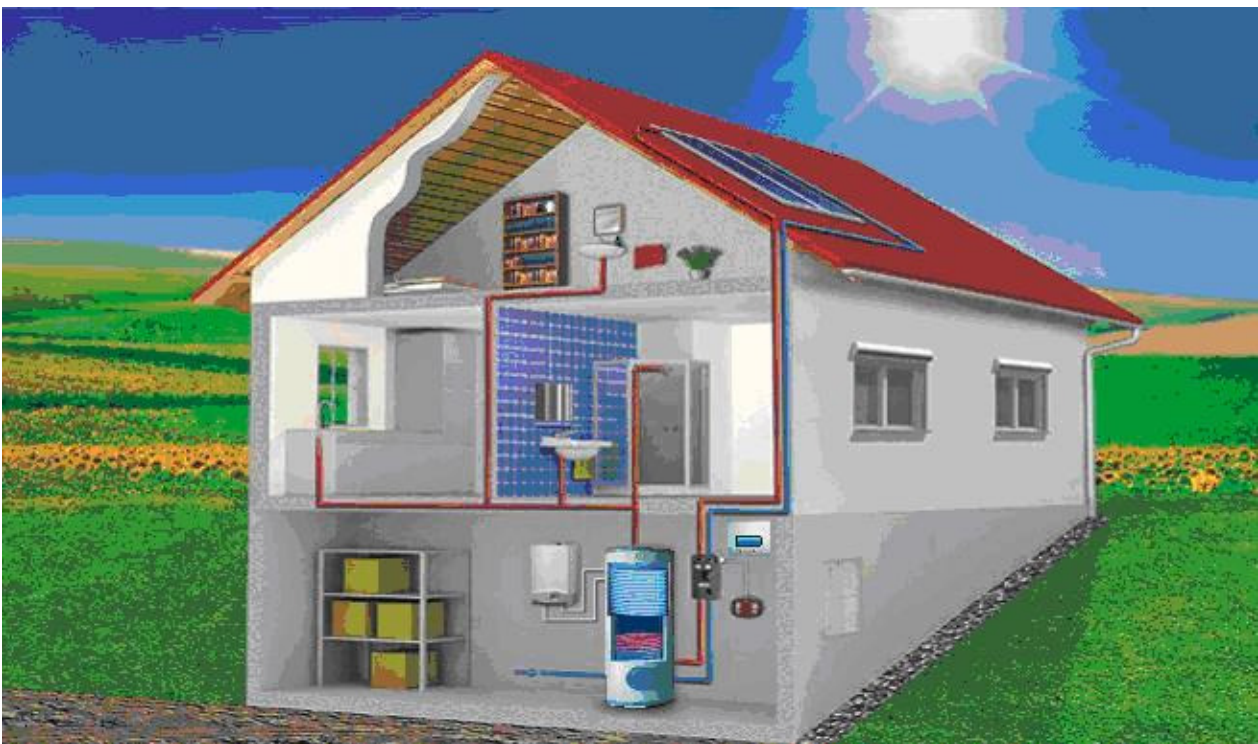
Рис.3. Приклад роботи сонячної системи для гарячого водопостачання
