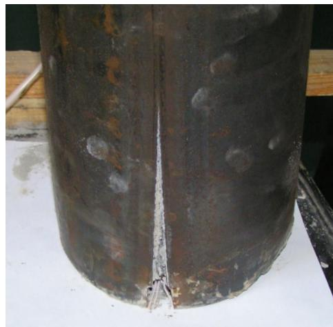
Рис.2. Разрыв обоймы по сварному шву в образце 2.6.
