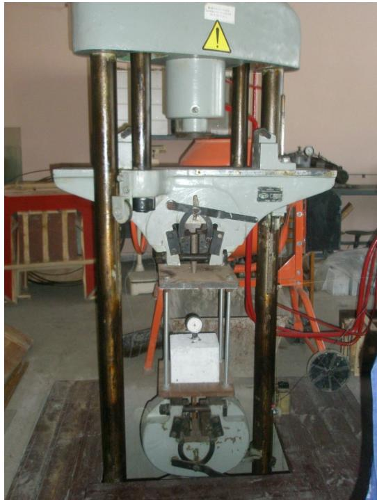
Рис.3. Загальний вигляд висмикування арматури з призм в устаткуванні розривної машини УММ-50
