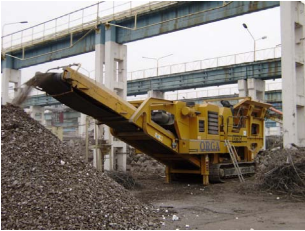
Рис. 3. Мобільне дробильне устаткування для переробки вторинної сировини
