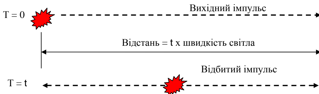
Рис. 8. Імпульсний метод вимірювання відстаней (великі відстані)
