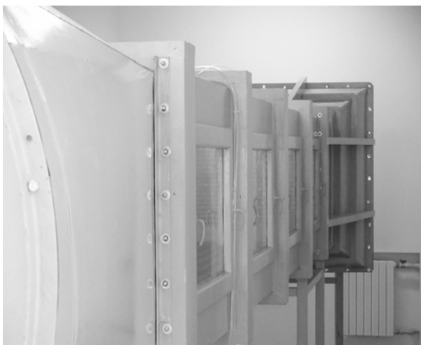
Рис. 2. Метеорологічна аеродинамічна труба МАТ-1: а) зовнішній вигляд; б) вид робочої частини.
