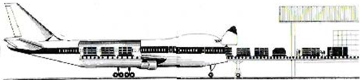
Рис. 3. Завантаження контейнерів у вантажний літак із будівлі вантажного аеровокзала.
