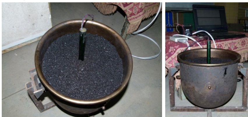
Рис. 4. Проведение эксперимента по определению интенсивности теплообменных процессов асфальтобетонной смеси с окружающей средой.
