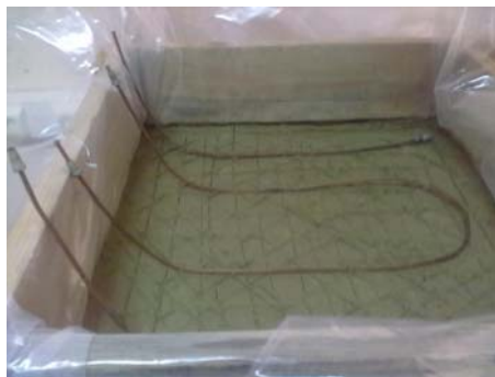
Рис. 3. Закладання мідних трубок в ґрунтову модель
