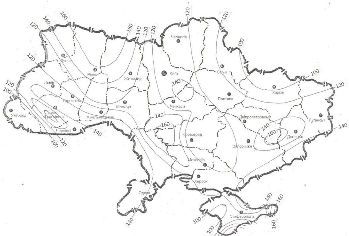
Рис.1. Максимальний добовий шар опадів ймовірністю перевищення P=1\% , мм.
