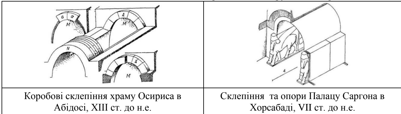
Рис.1. Співставлення єгипетських та асирійських конструктивних прийомів
