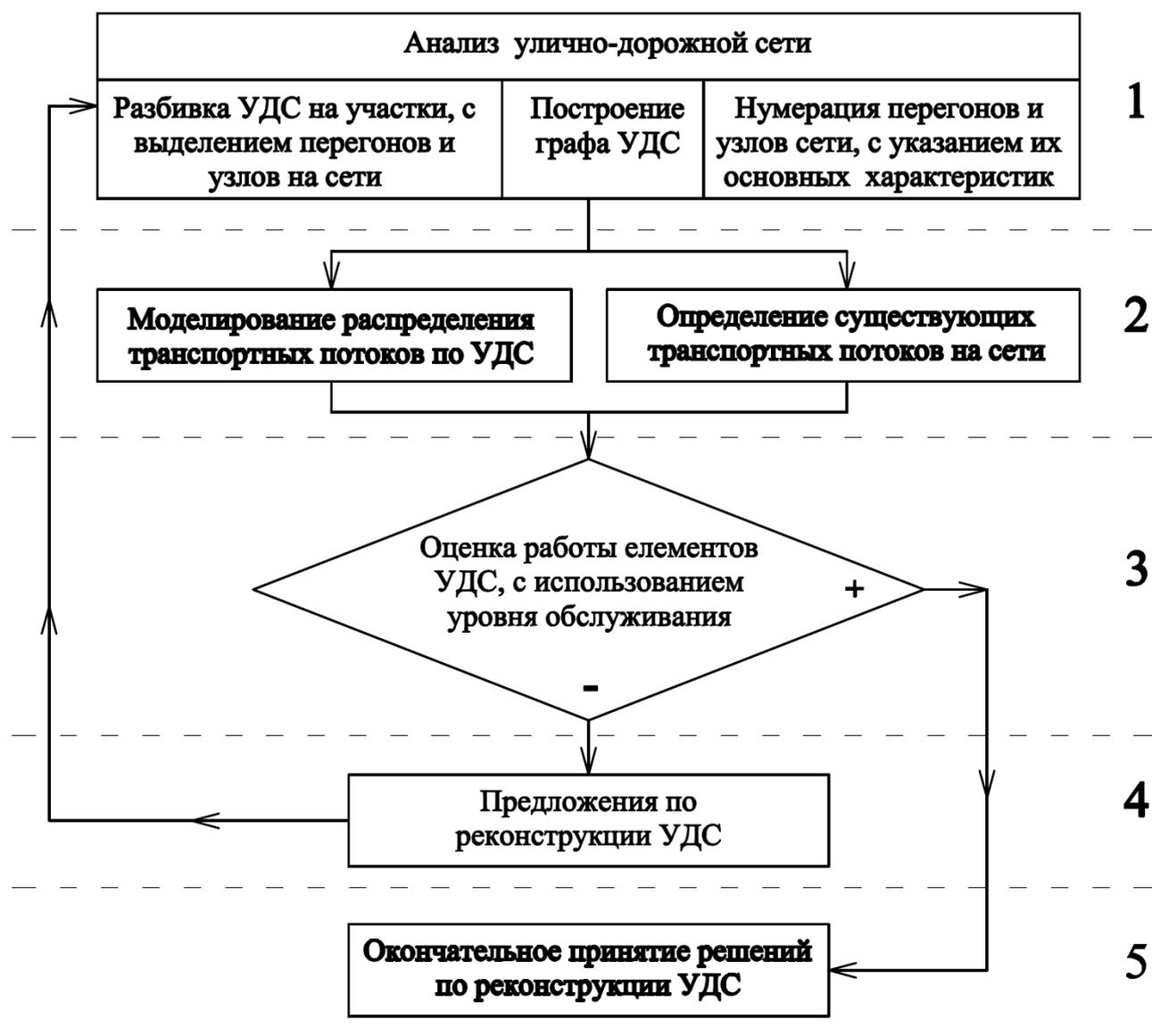
Рис. 1. Блок-схема принятия решений по реконструкции УДС
