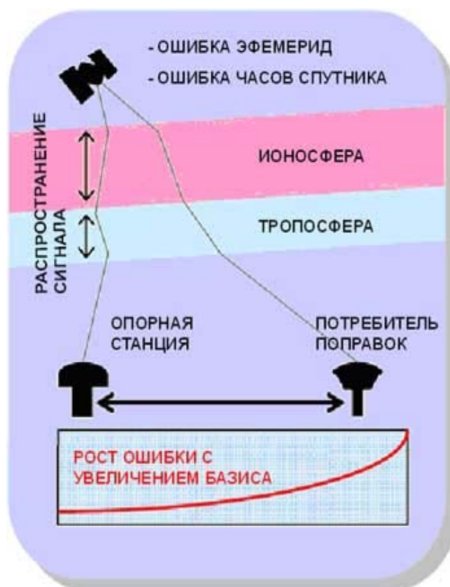
Рис. 1. RTK - устранение источников ошибок при относительном спутниковом определении
