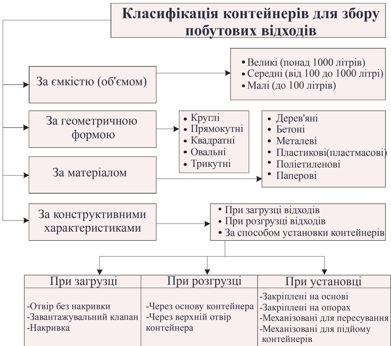
Рис. 3. Класифікація контейнерного обладнання
