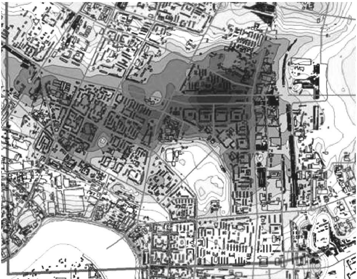
Рис.1. Моделювання зон підтоплення з використанням ГІС-технологій.
