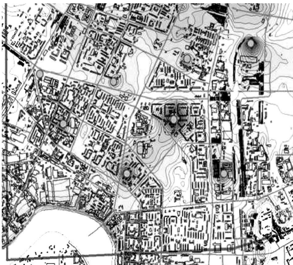
Рис.2. Моделювання роботи вертикального дренажу з використанням ГІС-технологій.
