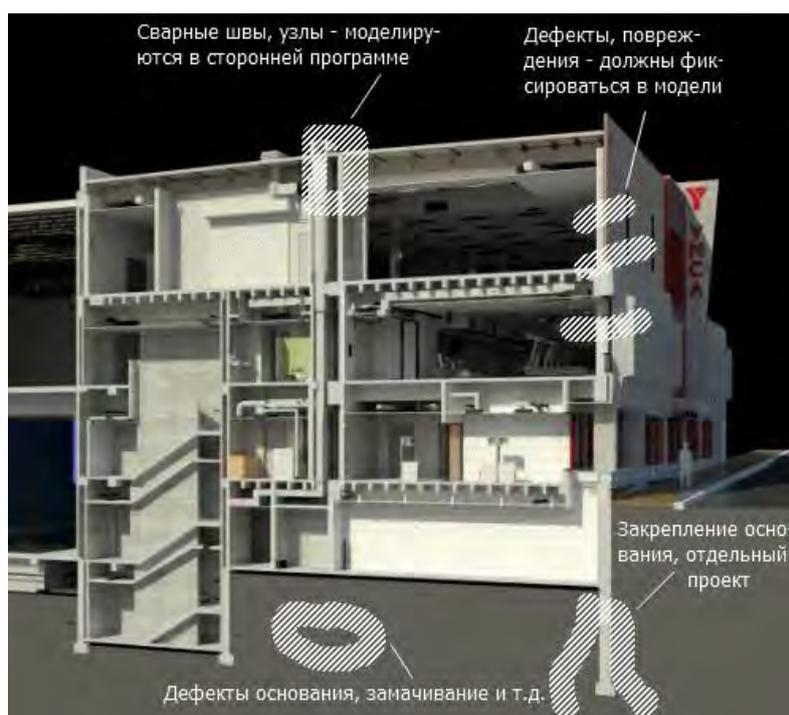
Рис. 1 – Пример использования BIM и потенциальные возможности отображения информации о здании (источник [Бауск А. Е. Менее оптимистичный взгляд на BIM / А. Е. Бауск : [Электронный ресурс]. – Режим доступа к ресурсу: [http://isicad.ru/ru/articles.php?article\\_num=14092.](http://isicad.ru/ru/articles.php?article_num=14092.)], подложка взята из примеров Autodesk Revit Structure)
