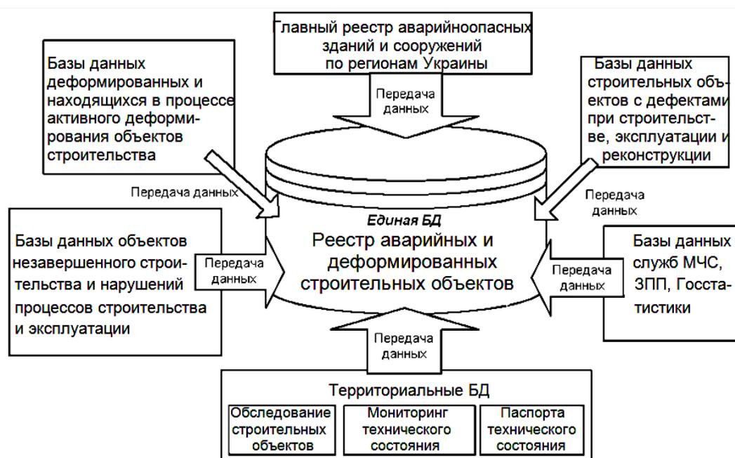
Рис. 2 – Базы данных, формирующие базу «Реестра аварийных и деформированных строительных объектов»
