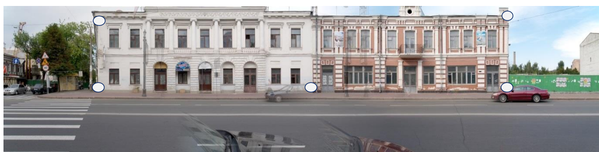
Мал. 2. Розташування 5 опознаків, які розташовані на кутах об'єкта та в середині.
