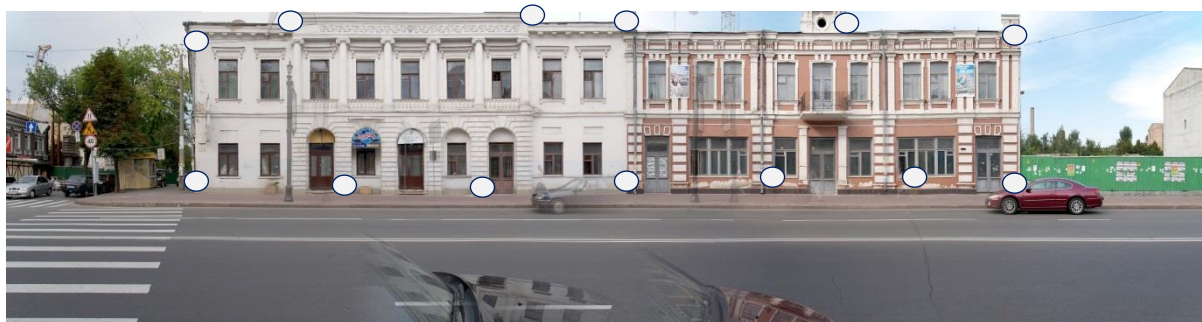
Мал. 1. Модель з 13 опознаками. Нижні розташовані проти знімальних станцій, верхні на характерних місцях даху.
