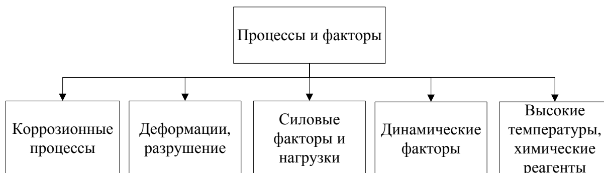
Рис. 1. Классификация основных факторов и процессов, обуславливающих образование повреждений и дефектов в арочных конструкциях и сводах
