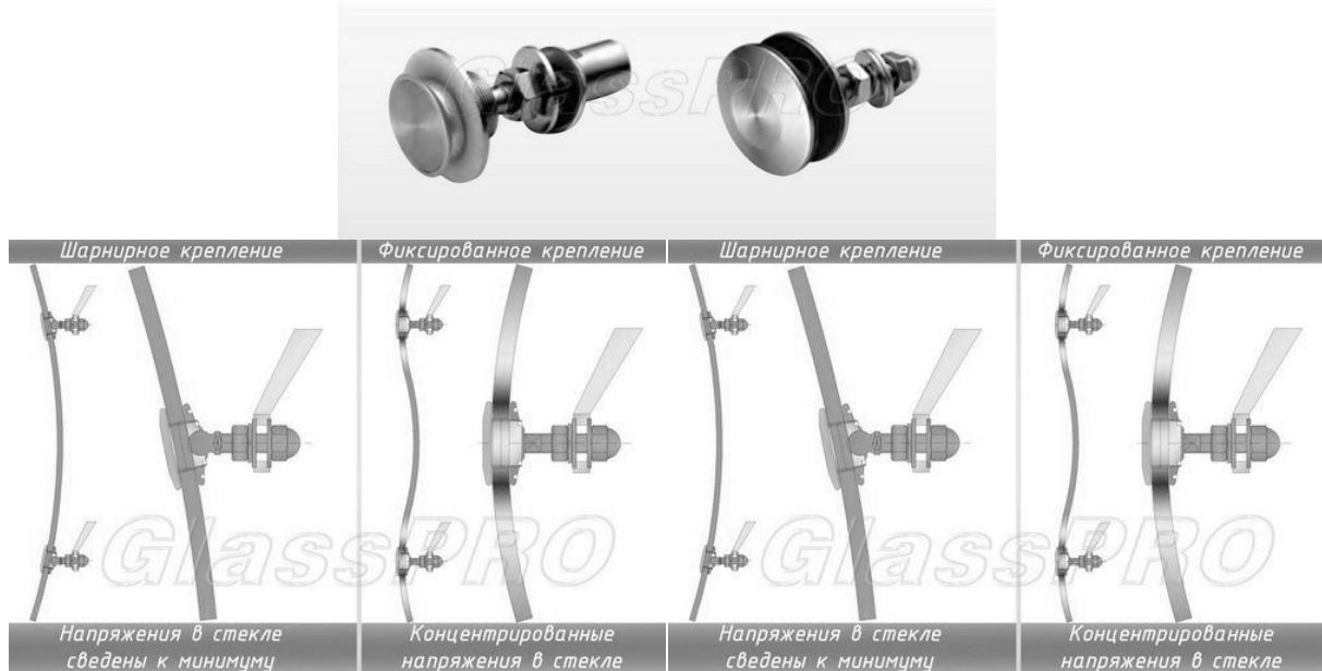
Рис. 5. Принцип роботи шарнірів у спайдерах
