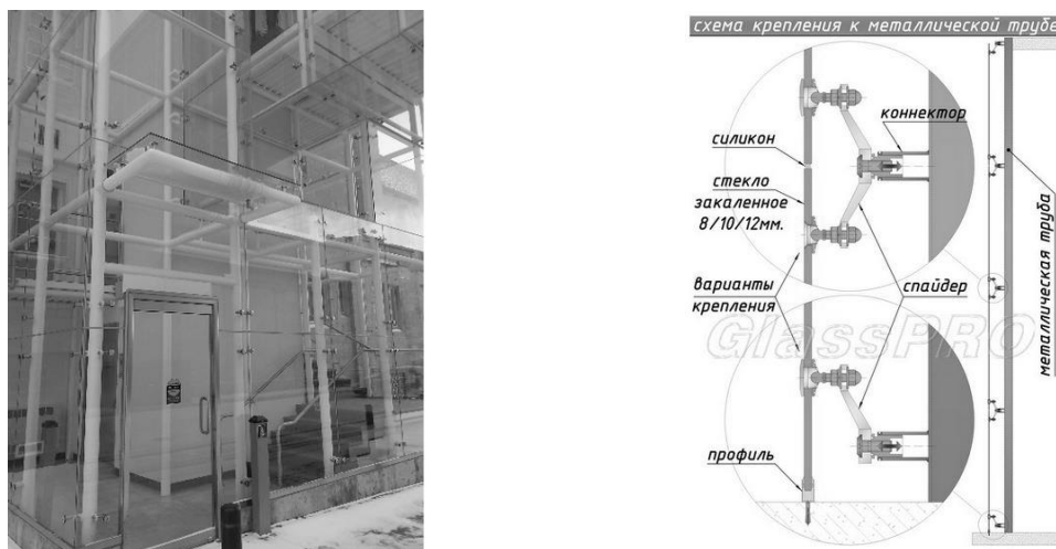
Рис.2. Кріплення спайдера до металевих колон
