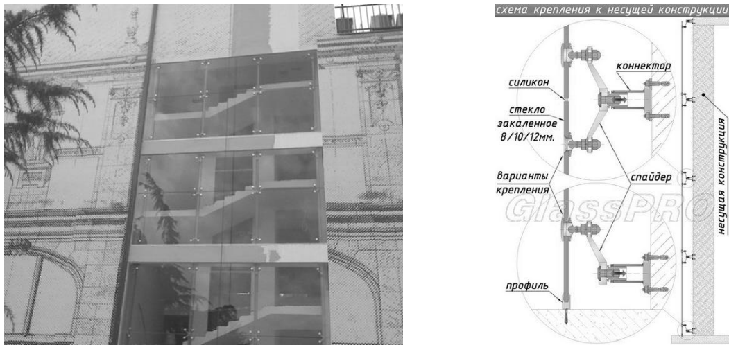
Рис.1. Кріплення спайдера до несучих конструкцій
