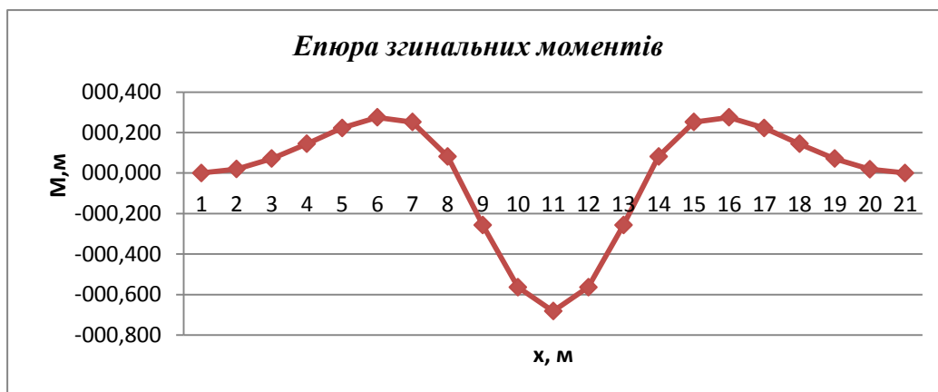
Рис.2. Епюра згинальних моментів (грунт – болото).
