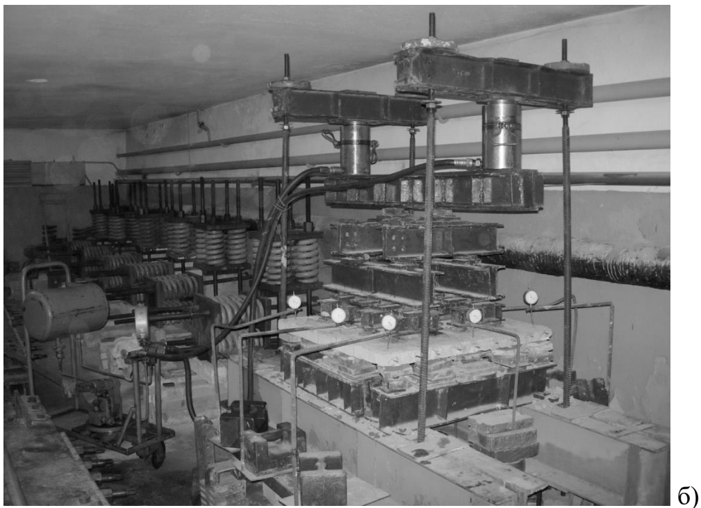
Рис.1. Схема завантаження плити (а) та загальний вигляд установки для випробування плит (б): 1 – індикатори-прогиноміри.
