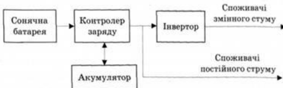
Рис.2. Принцип роботи сонячної установки.
