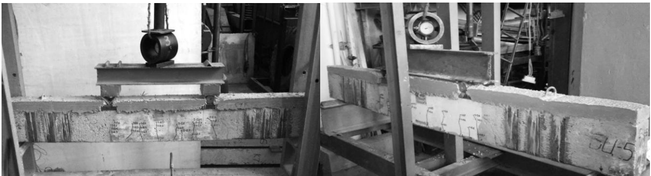
Рис.4. Підсилення дослідних балок БЦП-5 Б , БЦП-6 СФБ під навантаженням
