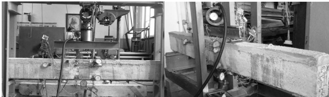
Рис.5. Вигляд установок та розташування приладів на балках БП-1 Б , БП-2 СФБ
