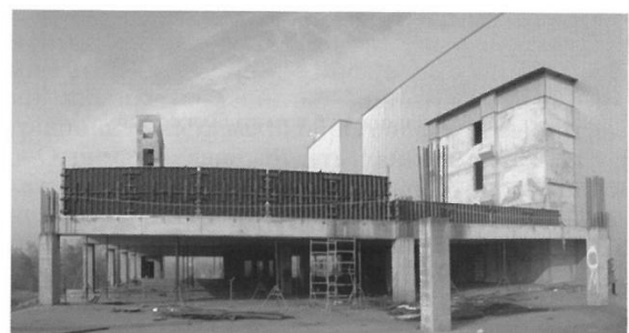
Рис.6. Випробування фрагменту перекриття другого поверху. Навантаження прикладається шляхом наповнення емкостей водою. Вигляд збоку
