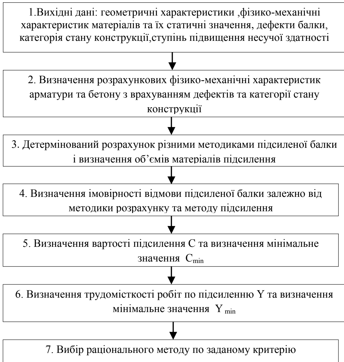
Рис. 1. Загальний алгоритм визначення раціонального підсилення залізобетонних балок
