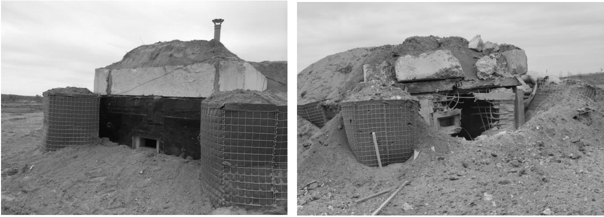
Рис. 9. Натурні випробування вогневих споруд на Житомирському полігоні: початковий вигляд, руйнування на знищення настільним влученням із САУ
