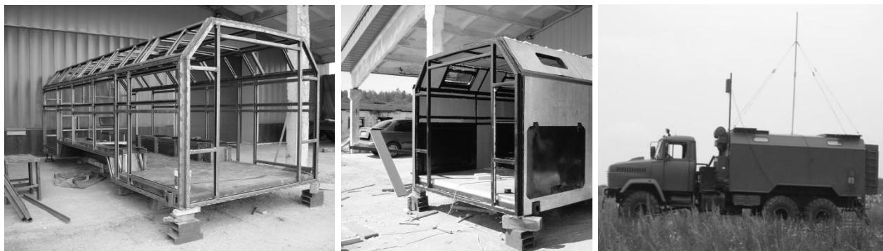
Рис.1. Кунг в процесі виробництва та РЛС у розгорнутому стані
