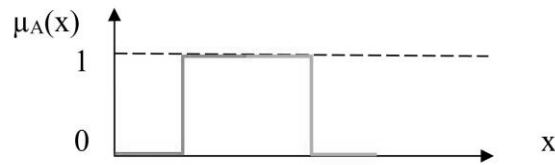
Рис.2. Графік функції приналежності \mu_A(x) нечіткої множини A , в випадку граничних значень 0 та 1, де x – елементи базової множини X .
