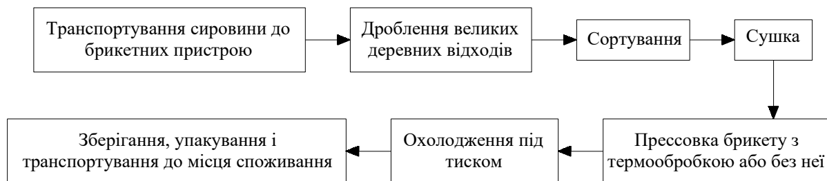
Рис. 4. Загальна схема процесу виробництва паливних брикетів.
