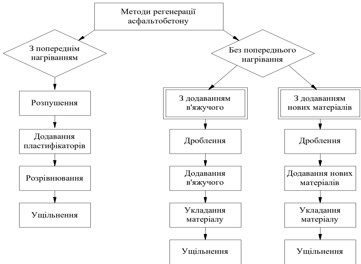
Рис. 3. Загальна схема регенерації асфальтобетону.
